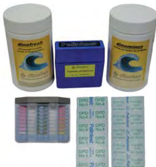
Zestaw startowy: naczynie testowe wraz z tabletkami DPD i Phenolred firmy DINOTEC
